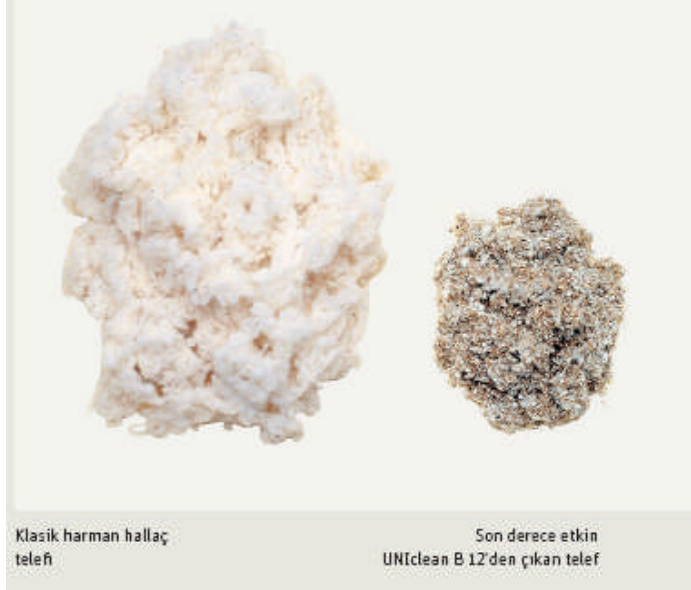
Resim 3.6: Klasik-modern harman hallaç dairesi makinelerinin telefleri
