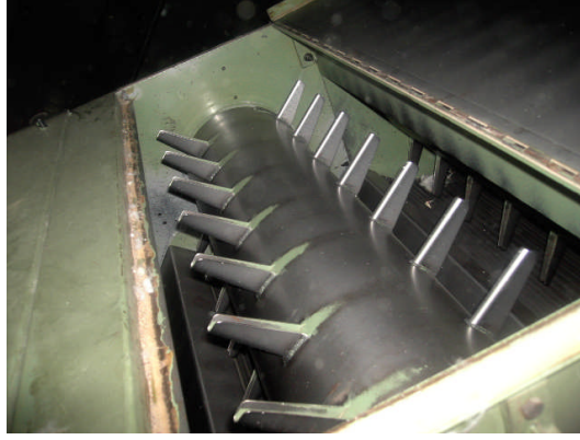
Resim 2.2: Kademeli açıcı dövücü (açıcı) silindiri
