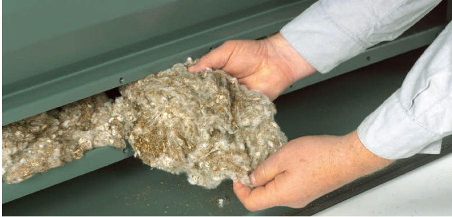
Resim 3.4: Tek silindirli temizleyici (Unclean B 12) makinesinden çıkan telef
