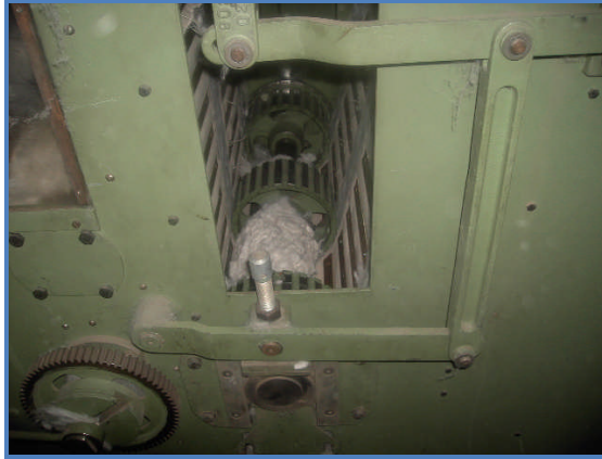
Resim 1.6: Telef açıcı temizlik noktaları
